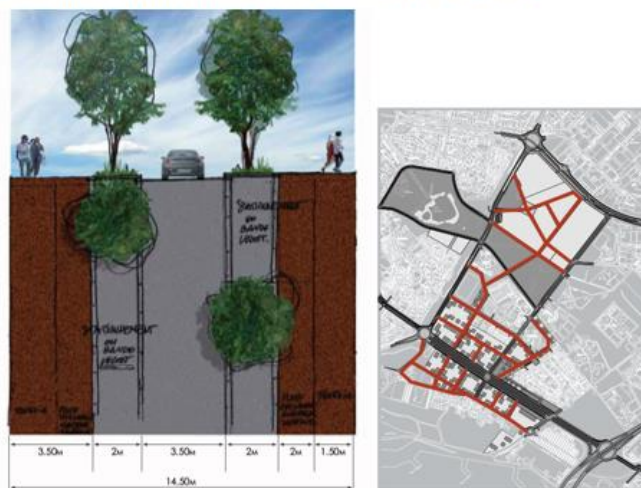
Figure 1 : Profil en travers proposé au droit des futures voies internes du périmètre
