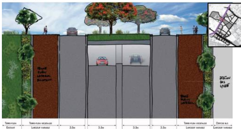
Figure 2 : Profil en travers proposé pour la RN4a au droit du Parc Boisé existant
